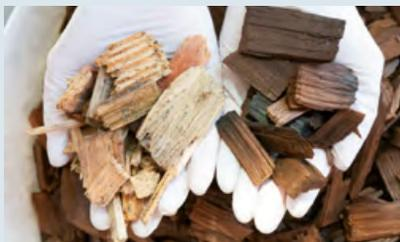
Torrefiziertes Buchenholz (rechts) hat im Vergleich zu unbehandeltem (links) einen erhöhten Brennwert.
