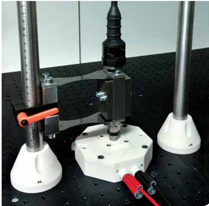
Versuchsstand zur aktiven Schwingungsreduktion im Labor. © Fraunhofer LBF
