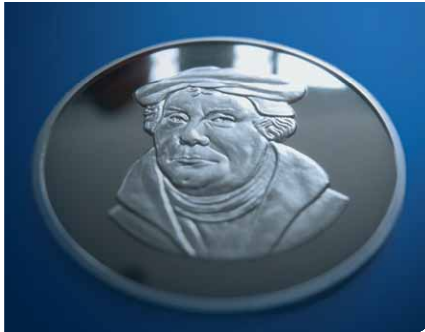
Pulvermetallurgisch hergestellte Silbermünze. Vorbild war eine historische Münze mit einem Motiv von Kaiser Franz Josef I (Bild links) – pulvermetallurgische Probestampung einer Münze aus 925 Sterlingsilber. Das Motiv zeigt Martin Luther (Bild rechts). © Fraunhofer IFAM
