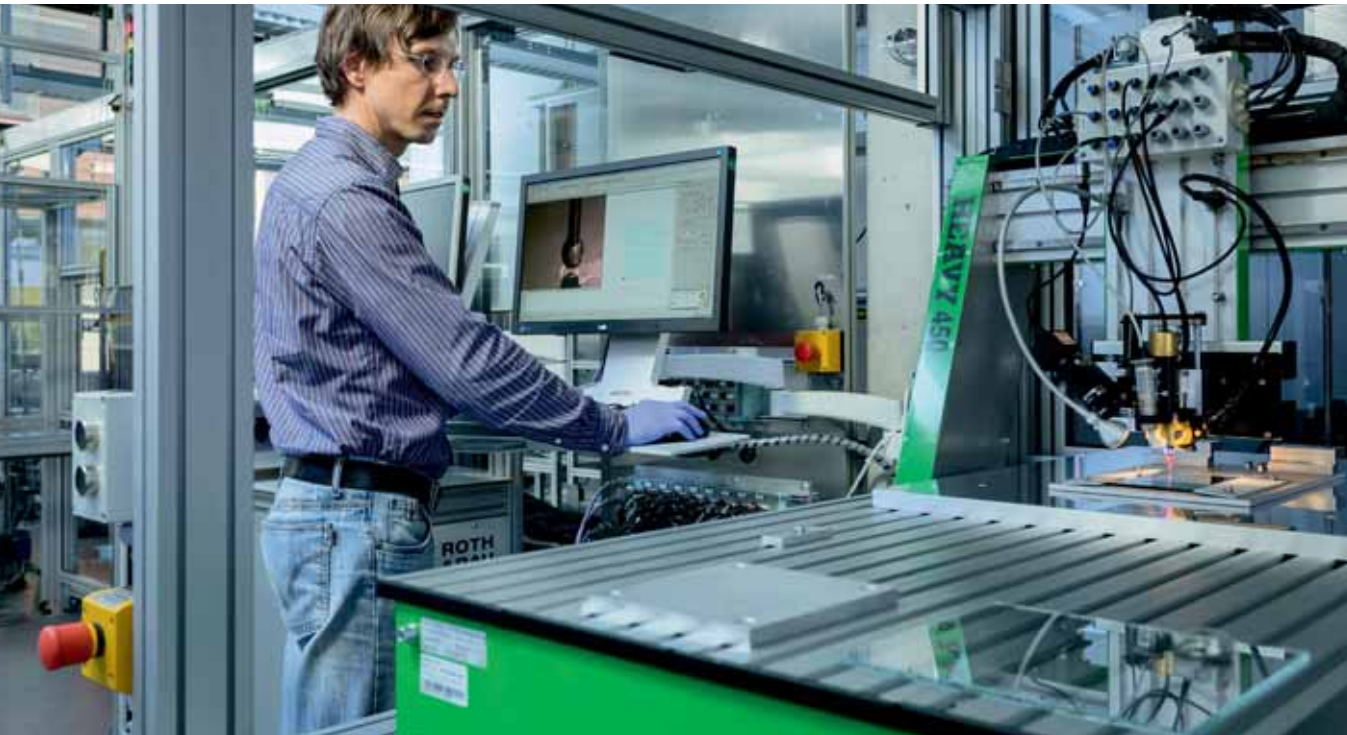
Fertigungszelle für Direct-Write-Technologien, integriert in einer Fertigungsstraße für funktionalisierte Bauteile. © Thomas Kleiner/Fraunhofer IFAM
