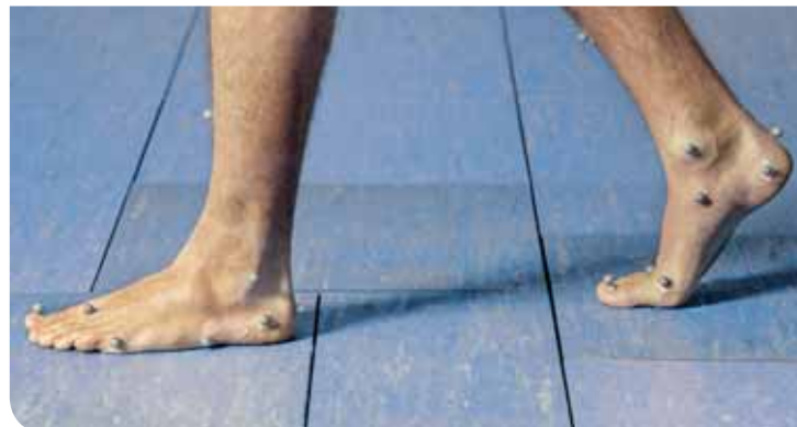
links: Bewegungsanalyse mit hochauflösendem Infrarot-Tracking-System. © Fraunhofer IPA
