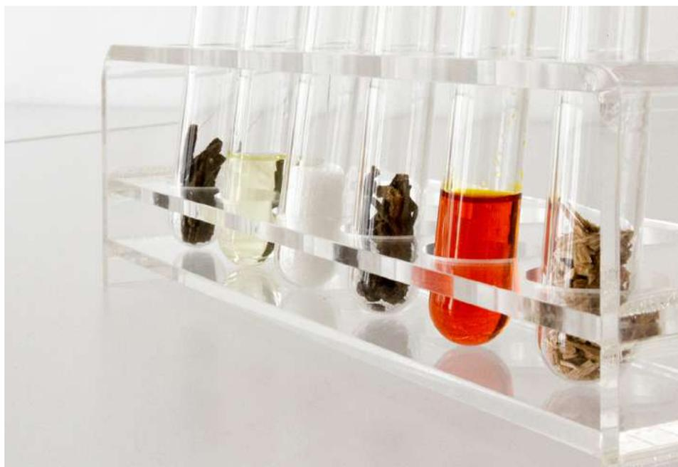
*Fraktioniertes Gärprodukt sowie Endprodukte wie Düngergranulat, Flüssigdünger und Einstreupellets.*
