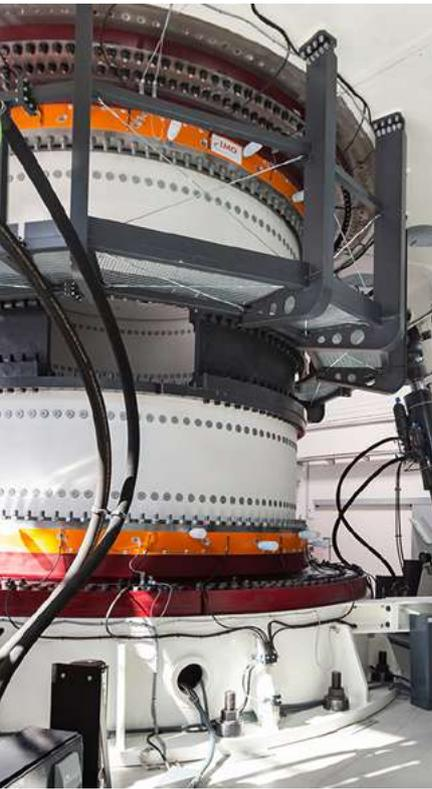
*Im Großlagerprüfstand BEAT6.1 werden beim Fraunhofer IWES Rotorblattlager mit bis zu 6 Meter Durchmesser für Offshore-Windenergieanlagen getestet.*
