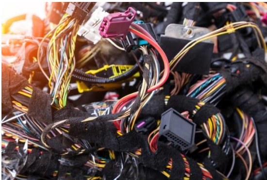
Abb. 2 Symbolbild Kabelbaum: Die zentrale Verwaltung benötigt weniger Kabel, wodurch in der Herstellung Materialaufwand und Kosten sinken. Das Fahrzeug wird insgesamt deutlich leichter.
