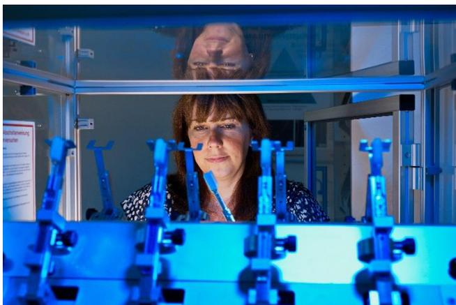
**Abb. 2** In einem Zahnputzsimulator wurde während der In-vitro-Studie die tägliche mechanische Reinigung der Zähne simuliert.
