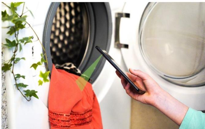
**Abb. 1** Wenn der Zettel mit dem Reinigungshinweis nicht mehr lesbar ist: Ein kurzer Check mit dem Smartphone und der integrierten Spektralanalyse erkennt das Gewebe des Kleidungsstücks. Damit lässt sich der korrekte Waschgang einstellen.
