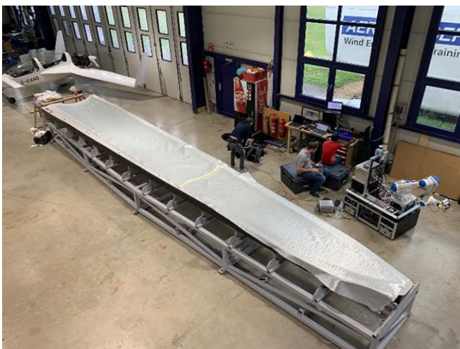
Abb. 1 Form einer Rotorblattspitze mit ausgelegten Faserlagenpaket bei Aeroconcept GmbH
