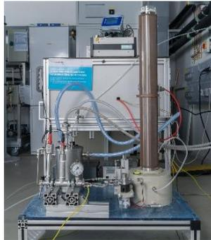
**Abb. 3: Versuchsanlage zur Eliminierung von PFAS. Nach ersten erfolgreichen Versuchen soll die Technologie auch für praktische Anwendungen im Industriemaßstab optimiert und skaliert werden.**
