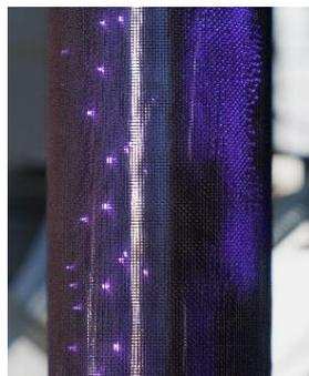
**Abb. 1 Die Plasma-Atmosphäre wird im Reaktor durch das charakteristische Leuchten und das Entladen von Blitzen deutlich sichtbar.**
