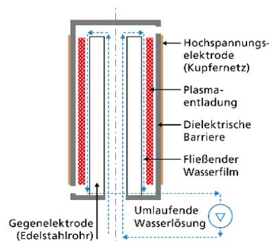
**Abb. 2 Plasma-Reaktor: Durch Anlegen von Spannung an der Kupferelektrode entsteht ein Plasma. Kontaminiertes Wasser wird nach oben gepumpt und fließt in einem Spalt durch die Zone mit der Plasma-Entladung wieder nach unten. Dabei werden die PFAS angegriffen.**
