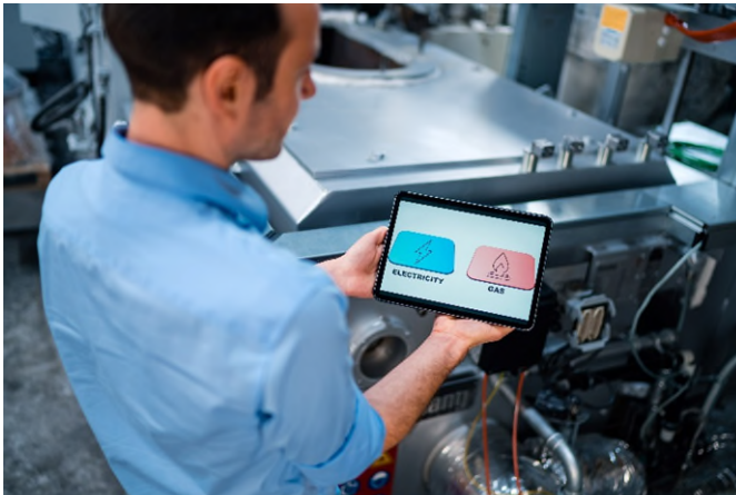
Abb. 2 Bivalente Tiegelöfen können im Betrieb dynamisch zwischen den Energieträgern Strom und Gas wechseln.
