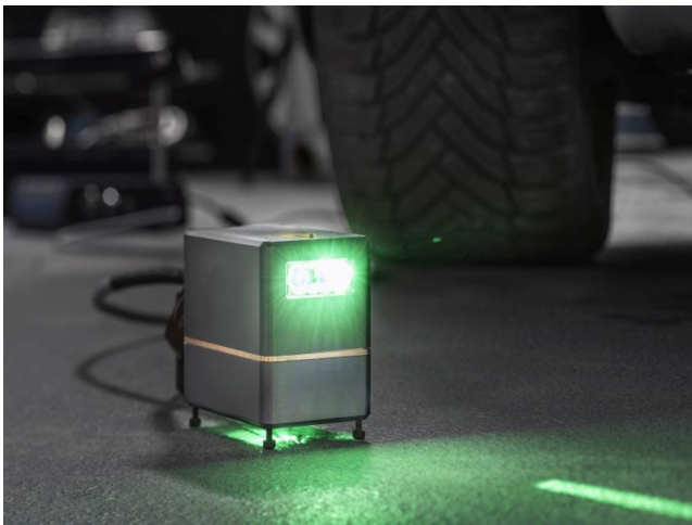
Abb. 2 Mit 7x7x5 cm kann der Projektor in jeden Autoschweller eingebaut werden und eine Projektionsfläche von 100x30 cm abdecken.
