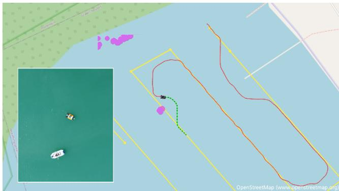
**Abb. 2** Das USV umfährt autonom ein auslaufendes Schlauchboot. In der Kartendarstellung sind der zur Kartierung geplante Weg (gelb), die tatsächliche Fahrstrecke (rot) und das in Echtzeit geplante Ausweichmanöver (grün) eingezeichnet.
