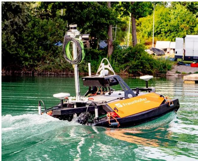
**Abb. 1** Das im Projekt TAPS mit Autonomiefähigkeiten und Sensoren zur Über- und Unterwasserkartierung ausgestattete USV in Aktion
