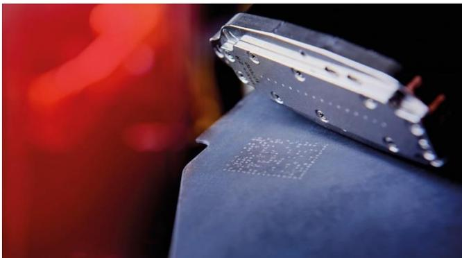
**Abb. 1 Data-Matrix-Code auf Warmumformblech, gedruckt mit Industriedrucker**
