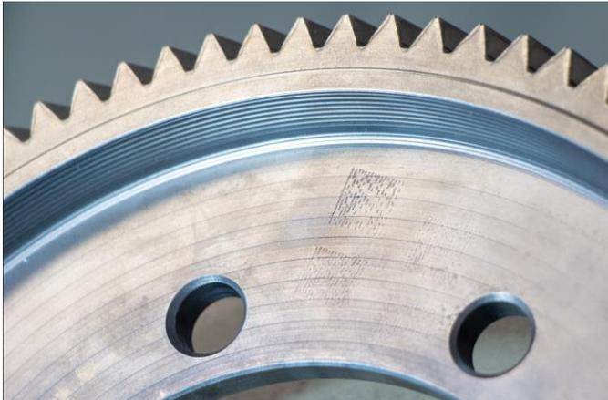
**Abb. 2 Gedruckter Data-Matrix-Code auf einem Metallbauteil**
