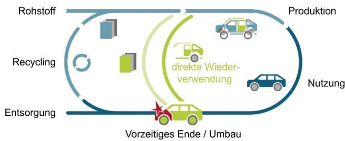
Abb. 1 Das Kreislaufkonzept von EKODA soll die einseitige Fixierung auf Recycling auflösen und mithilfe eines Bewertungssystems die Eignung von Komponenten für die Wieder- oder Weiterverwendung prüfen.
