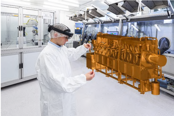
Abb. 3 Modell einer Glovebox – Behälter der gegenüber der Umgebung hermetisch und gasdicht abgeschlossen ist – in HoloLayouts
