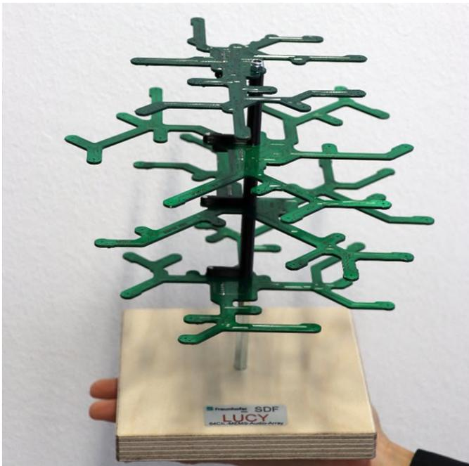
**Abb. 2** Die MEMS-Mikrofone werden in einer speziellen geometrischen Anordnung im Array angebracht und können Schall aus allen Richtungen aufnehmen. Aktuell umfasst das Array 48 Mikrofone, künftig sollen es 256 Mikrofone werden.
