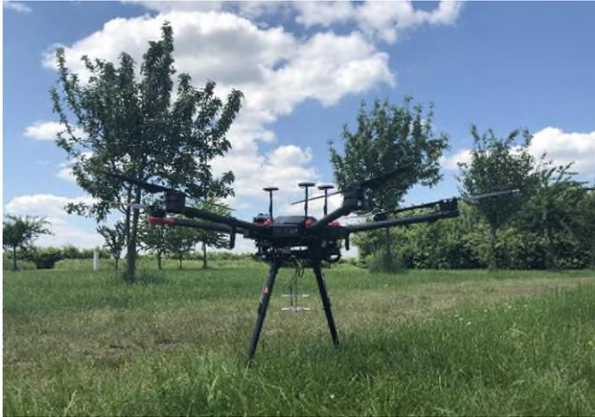
**Abb. 3** Das Array von MEMS-Mikrofonen, das sogenannte Krähenest-Array, wird an eine Drohne montiert. Hilfeschreie und Klopfgeräusche können so aus der Luft entdeckt und es kann ihre Herkunft bestimmt werden.
