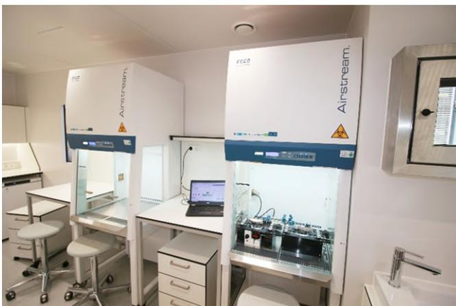
**Abb. 2 Zwei modulare Klasse-II Sicherheitswerkbenke für BSL-2 Arbeiten**
