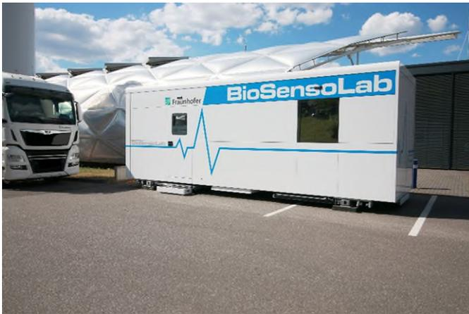
**Abb. 1 Mobile Laboreinheit mit integrierter Hubeinrichtung für Standard-LKW-Fahrgestelle**
