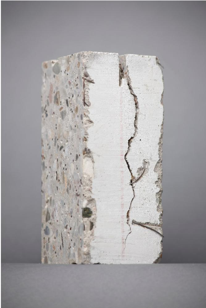
**Abb. 1** Betonprobe mit Riss.
