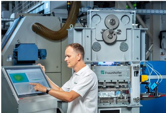
**Abb. 1** Anhand eines Umformpressen-Demonstrators können sich Besuchende live ein Bild über die Funktionsweise des intelligenten Nutzensteins machen. Die vom smartNotch übertragenen Prozessdaten werden dabei auf einem angeschlossenen Terminal visualisiert.
