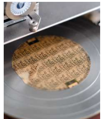
Halbleiter-Wafer mit GaN-Transistoren für 5G- und 6G-Basisstationen.
