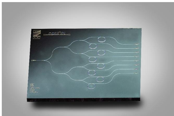
**Abb. 1** Ein im Projekt optION entwickelter photonischer Sensorchip mit acht Sensorkanälen in der Materialplattform Siliziumnitrid.
