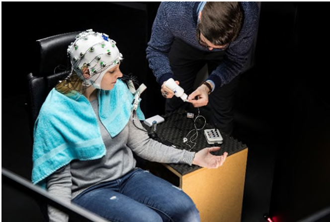
Abb. 2 Mathias Vukelic bereitet eine EEG-Messung vor und stellt mithilfe von Gel eine bessere Leitfähigkeit der Elektroden her.
