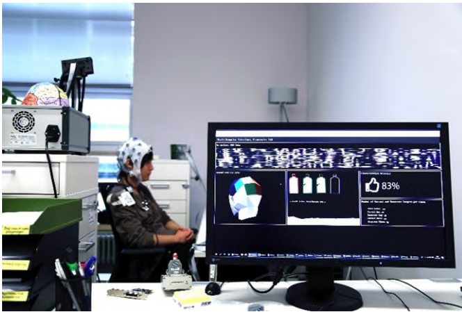
Abb. 3 In den Probandentests setzt das Forschungsteam multimodale neurophysiologische und psychophysiologische Messverfahren sowie Verfahren des Maschinellen Lernens ein, um herauszufinden, wie stark die Testperson emotional und kognitiv belastet ist – z.B. bei der Bedienung einer Software.
