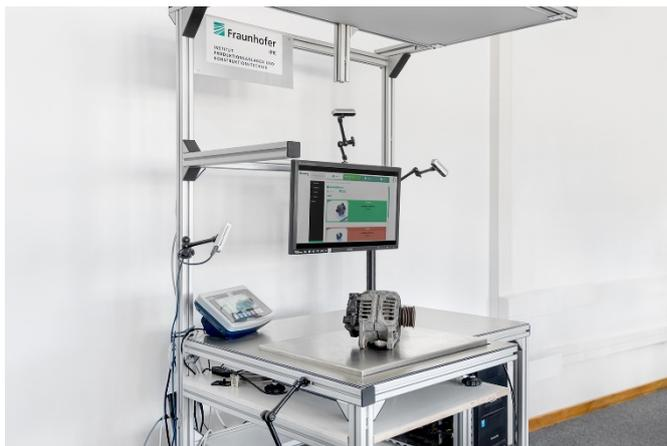
**Abb. 1 KI-unterstütztes Assistenzsystem zur teilautomatisierten Verlesung von gebrauchten Bauteilen.**
