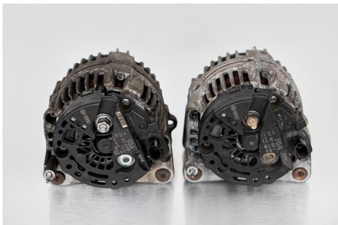
**Abb. 2 Produktvarianz – zwei Generatoren mit unterschiedlicher Teilenummer gleichen sich optisch.**
