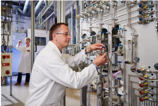
Abb. 2 Um die geeigneten Filtersubstanzen zu finden, nutzen die Forschenden des Fraunhofer IWS eine Multi-Adsorptionsanlage, womit das Adsorptionsverhalten gleichzeitig konkurrierender Gase untersucht wird.
