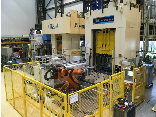
Abb. 1 Versuchsstand des Fraunhofer IWU für die Warmblechumformung: Ofen, Presse, Roboter.
