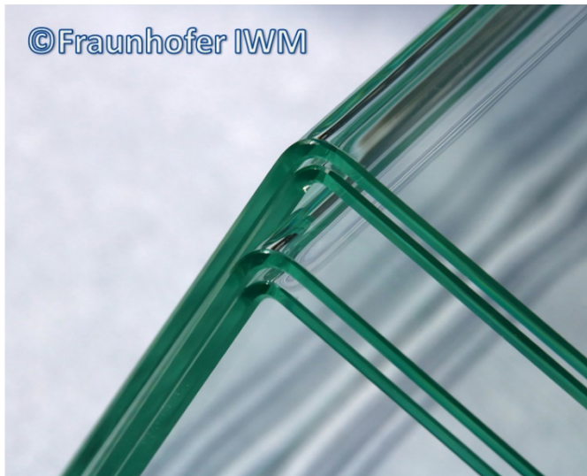
Abb. 2 Ergebnis des Glasbiegeprozesses: Um 90° Grad gebogene Glasscheiben.
