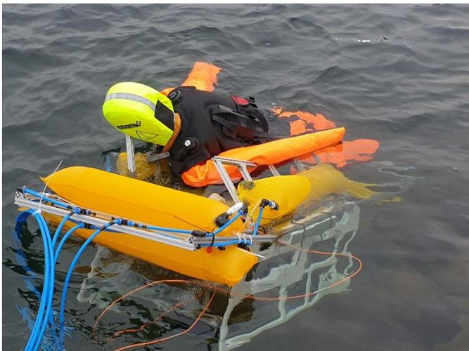
**Abb. 2** Der Wasserroboter transportiert den Dummy auf kürzestem Weg ans Ufer.
