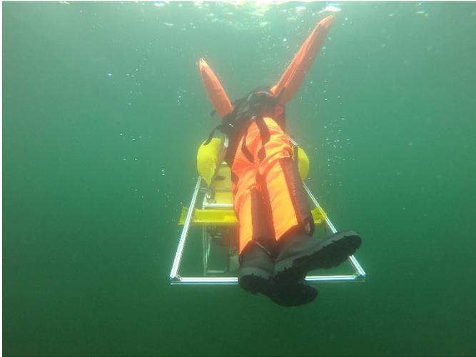
**Abb. 1** Beim Befördern an die Wasseroberfläche rutscht der Dummy beim Test im Hufeisensee nicht von der Fixiereinheit ab.
