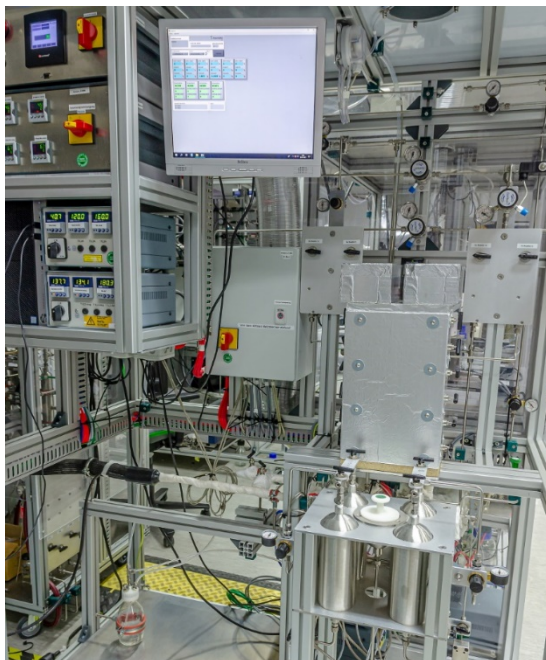
Abb. 3 Katalysator-Teststand: Hier lassen sich alle Funktionen und die Leistung der Abgasreinigung eines Katalysators testen. Insgesamt verfügt das Fraunhofer IMM über neun Teststände.
