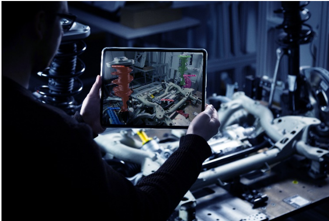
Abb. 1 Die Software MARQUIS erkennt sowohl, um welches Bauteil es sich handelt, als auch, ob es Abweichungen von den Soll-Maßen gibt.
