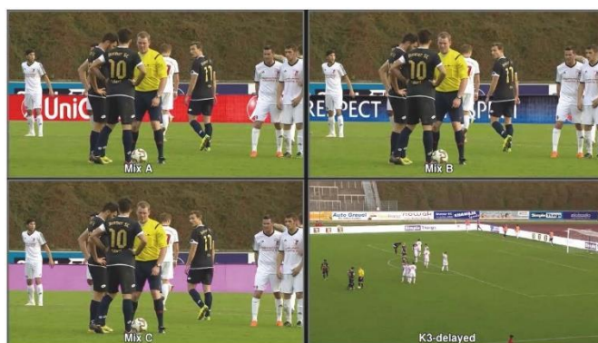
Abb. 2 Fußballspieler vor den LED-Banden. Die magentafarbene Fläche (links unten) erscheint nur für 2 ms, sie ist weder für die Zuschauer im Stadion noch für die TV-Zuschauer sichtbar. Diese sehen nur die für sie bestimmte Werbung.
