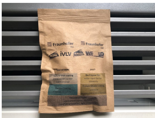
Abb. 1 Ein Siegelbeutel aus Papier mit der Beschichtung auf der Innenseite. Nach der Nutzung landet die Verpackung mit den bioaktiven Materialien in der Altpapiertonne.
