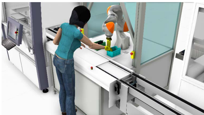
Abb. 2 Anwender haben mit dem Planungswerkzeug die Möglichkeit, unterschiedliche Roboter, Gefährdungssituationen und Werkzeuge zu kombinieren und sich so einen Katalog anzulegen und diesen laufend zu erweitern.
