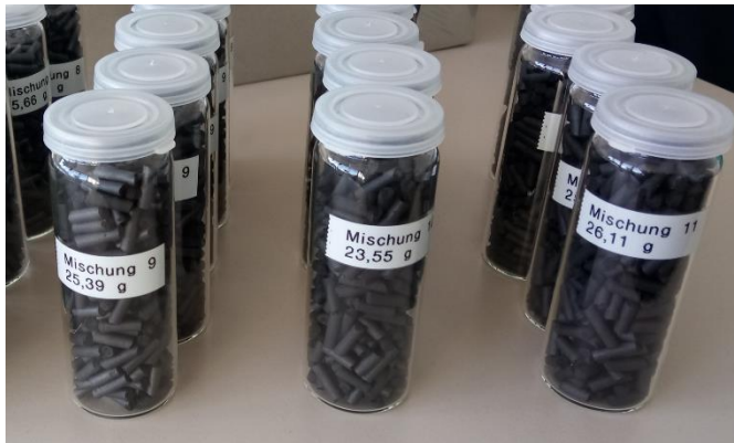
Abb. 1 Die hergestellten Komposit-Aktivkohlen weisen im Vergleich zu herkömmlichen granulierten Aktivkohlen eine dreifach höhere elektrische Leitfähigkeit auf.
