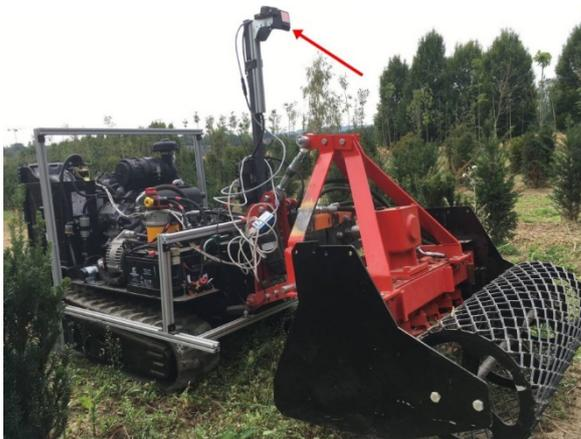
**Abb. 1** Die im AMU-Bot verbauten LiDAR-Scanner (roter Pfeil) senden während der Fahrt kontinuierlich Laserimpulse aus, mit deren Hilfe das System die Position der Pflanzenreihen erkennt.
