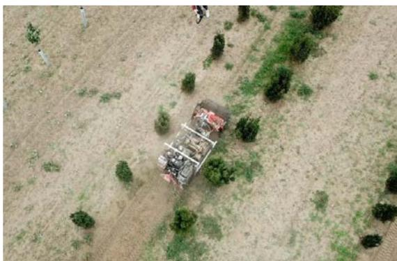
**Abb. 3** Das autonome Raupenfahrzeug AMU-Bot fährt in der Baumschule zwischen den Reihen entlang und entfernt das Beikraut.
