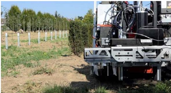
**Abb. 2** Der Manipulator fährt auch in Zwischenräume der Pflanzenreihen ein und entfernt hier das Unkraut mithilfe der Kreiselegen.
