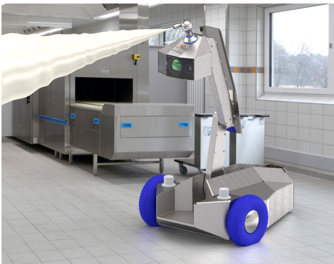
Abb. 1 Der ausfahrbare Roboterarm des Mobile Cleaning Device 4.0 mit Zielstrahlreiniger erreicht auch höher gelegene Anlagenbereiche
