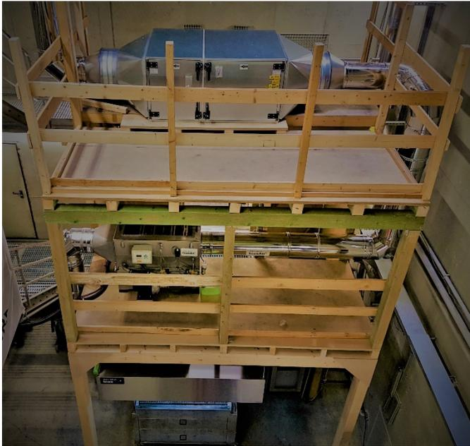
**Abb. 1** Für die Untersuchungen wurde im Labor des Instituts ein gewerblicher Grill mit einer meterhohen Abgasreinigungsanlage aufgebaut.
