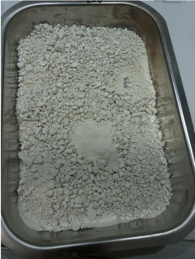
**Abb. 1** Recyceltes Phosphat aus Klärschlammasche, gewonnen mit dem P-bac-Verfahren.
