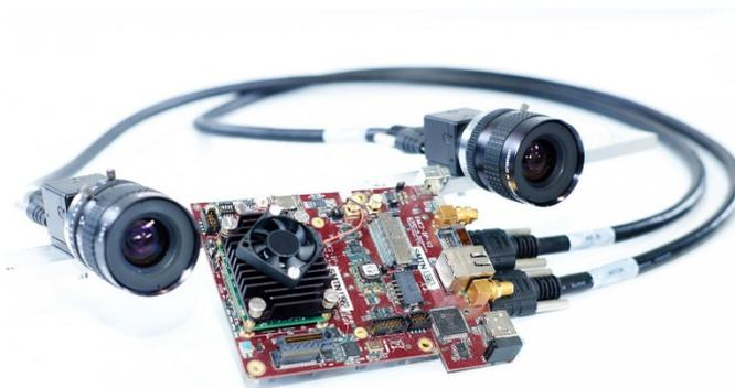
**Abb. 2** Die Stereokamera und das eingebettete System aus der Drohne.
