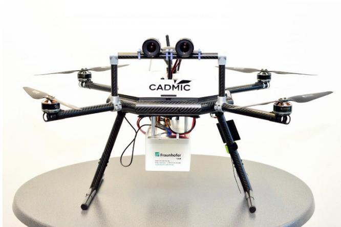
**Abb. 1** Drohne mit Stereokamera. In dem weißen Kästchen sitzt das eingebettete System, das die leicht versetzten Bilder der beiden Kameras in Echtzeit auswertet und Hindernisse erkennt.
