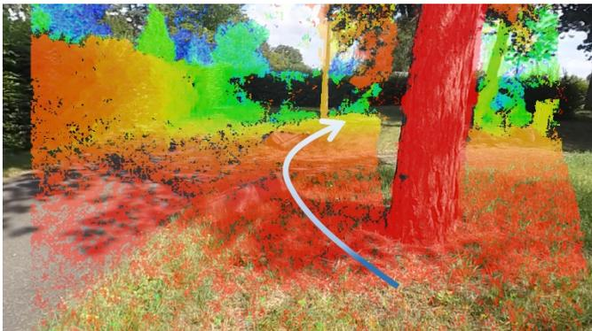
**Abb. 4 Dasselbe Bild mit der überlagerten Tiefeninformation aus der Stereobildauswertung, rot markiert Hindernisse in der Nähe. Der Pfeil deutet die darauf basierende Ausweichempfehlung an.**
