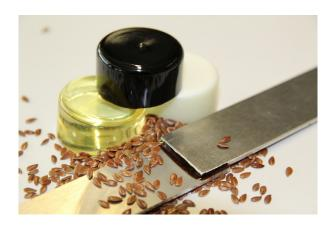
Abb. 1 Zwei Metallstücke sind mit der nachhaltigen Klebstoffformulierung verbunden. Im Hintergrund: Leinölepoxidproben für die Klebstoffprüfung mit flüssigem (gelb) und pastösem Härter (weiß) sowie mit Organosolv-Lignin (schwarz).
