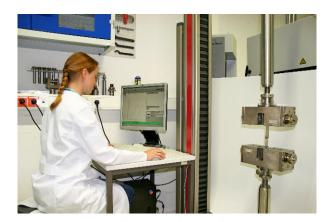
Abb. 3 Auswertung der Messkurve und Bestimmung der Zugscherfestigkeit.
