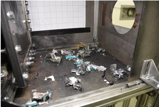
Abb. 3 Fragmente der Batterie im Prüfstand nach dem Aufpralltest auf eine Alumini-umplatte.
