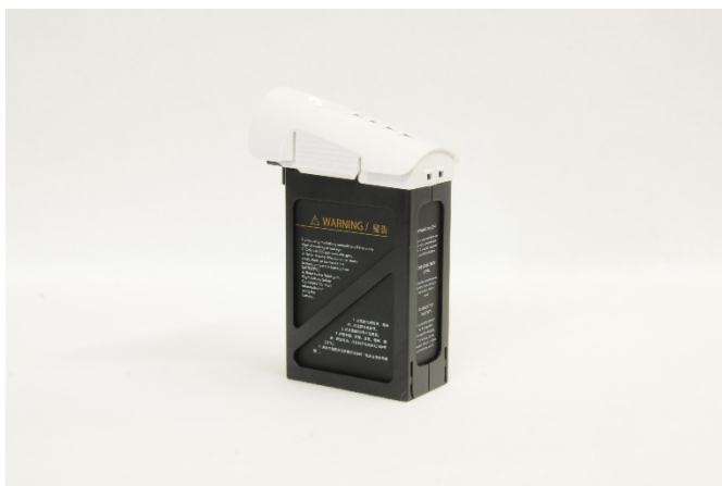
Abb. 2 Typischer Lithium-Ionen Akku (Masse circa 700 Gramm), wie er in einer Drohne verbaut wird.
