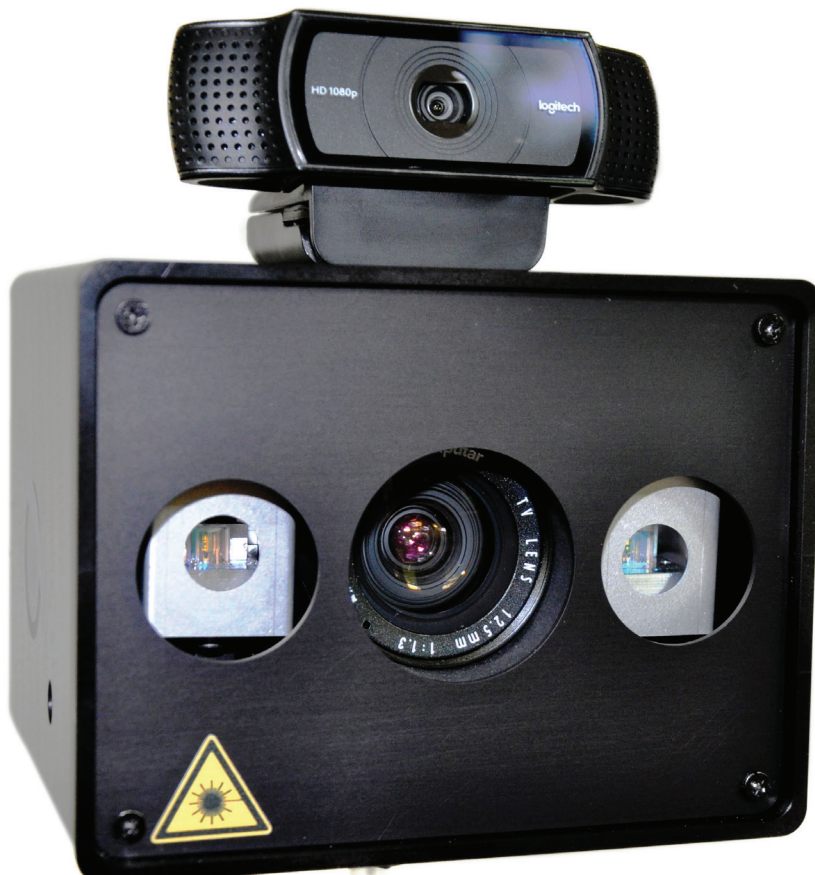
LiDAR OWL – die Time of Flight-Kamera, die bei Mährobotern zum Einsatz kommen könnte. © Fraunhofer IMS | Bild in Farbe und Druckqualität: www.fraunhofer.de/presse .
