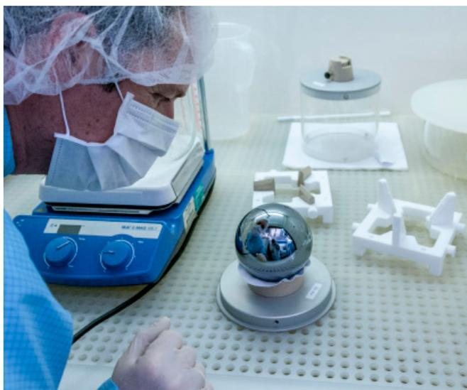
Die zu beschichtende Siliziumkugel muss wie ein rohes Ei behandelt werden. Rechts im Bild: eine der Dreipunktauflagen. © Fraunhofer IST | Bild in Farbe und Druckqualität: [www.fraunhofer.de/presse](http://www.fraunhofer.de/presse).
