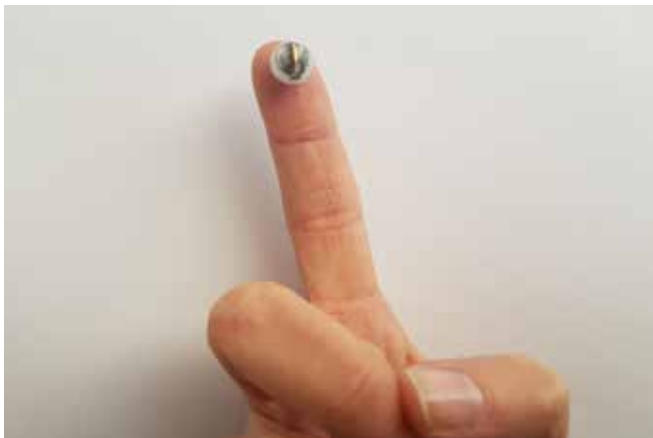
Mit der miniaturisierten Funk-schaltung im Innern der Kugel lassen sich die Messdaten live an eine Basisstation übermitteln. © Fraunhofer ENAS | Bild in Farbe und Druckqualität: www.fraunhofer.de/presse .
