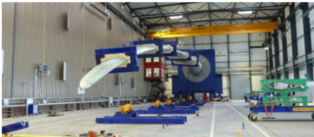
Endkantenüberwachung im statischen Rotorblatttest. Hierbei konnten die Schallemissionssensoren alle Schäden orten. © Fraunhofer IWES | Bild in Farbe und Druckqualität: [www.fraunhofer.de/presse](http://www.fraunhofer.de/presse).
