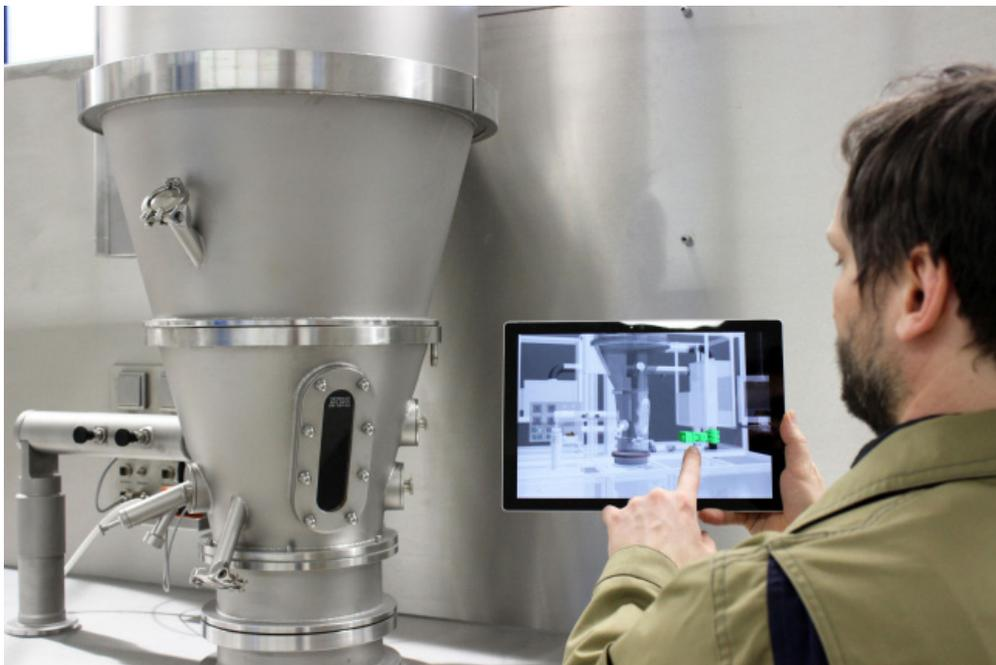
**Digitale Anlagenüberwachung für die vorausschauende Instandhaltung. Die dafür notwendige Vernetzung der Anlagen basiert auf ihrem digitalen Zwilling. © Fraunhofer IFF | Bild in Farbe und Druckqualität: [www.fraunhofer.de/presse](http://www.fraunhofer.de/presse).**
