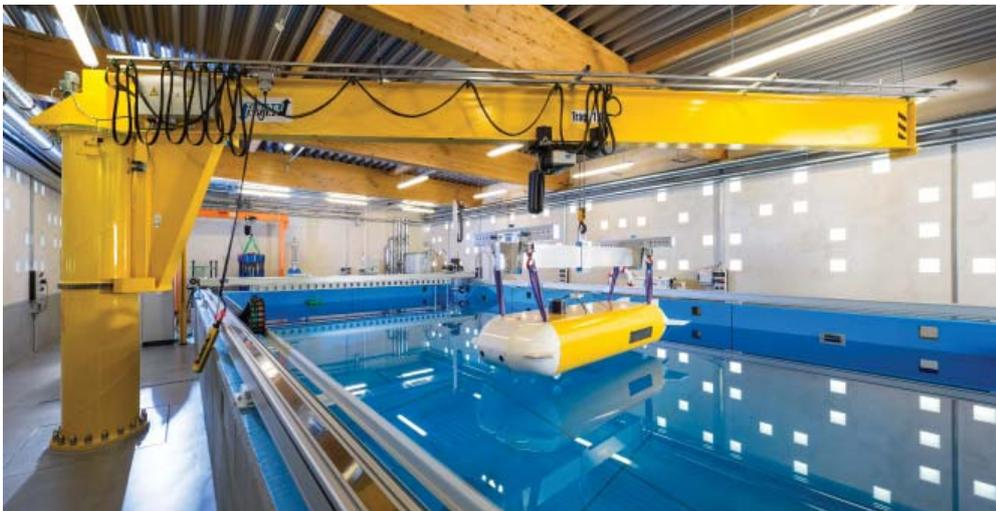
Das Unterwasserfahrzeug über der Forschungsplattform Maritime Systeme mit Schwenkran, Portalsystem und Druckkammer im Hintergrund links. © Fraunhofer IOSB-AST | Bild in Farbe und Druckqualität: [www.fraunhofer.de/presse](http://www.fraunhofer.de/presse).
