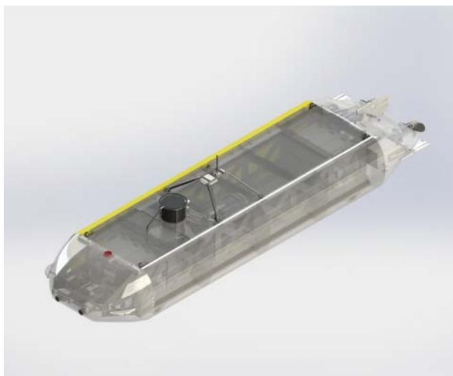
Das autonome Unterwasserfahrzeug kann in Tiefen von 6000 Metern vordringen.
