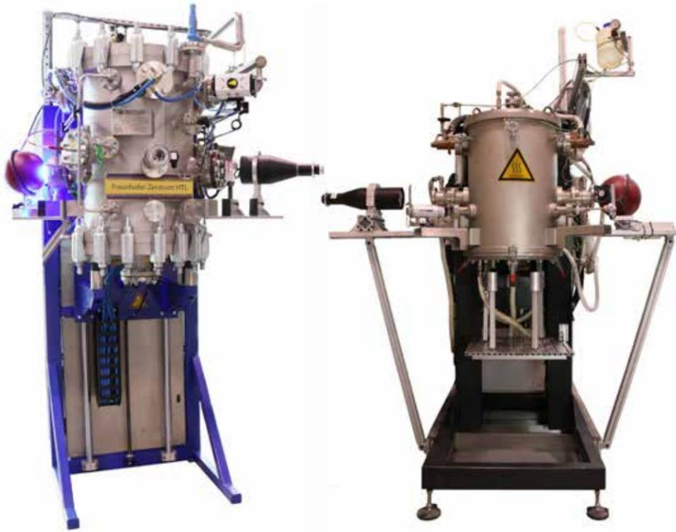
ThermoOptische Messanlagen (TOM) zur in-situ-Untersuchung des Einflusses von Wasserstoff und der Wasserstoffverbrennungsumgebung auf das Brenngut und die Ofenkomponenten
