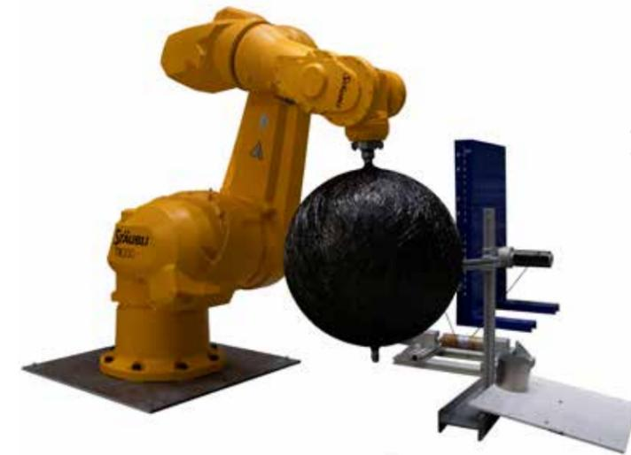
Herstellung eines isotensoiden Kugeltanks im KuWaTa-Projekt
